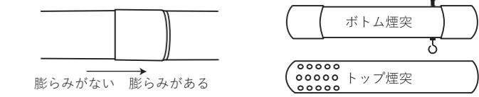
※ 煙突が組み立てにくい場合、右図のように先端を斜めに挿入後、回しながら押し込むと組み立てやすくなります。
