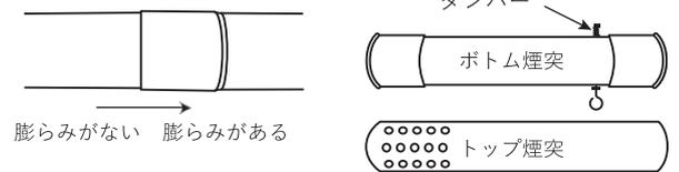
※煙突の長さはお好みで延長いただけますが、ボトム煙突とトップ煙突は必ずご使用ください。
