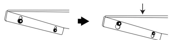
①バッフル固定用ボルトにバッフルを差し込む
