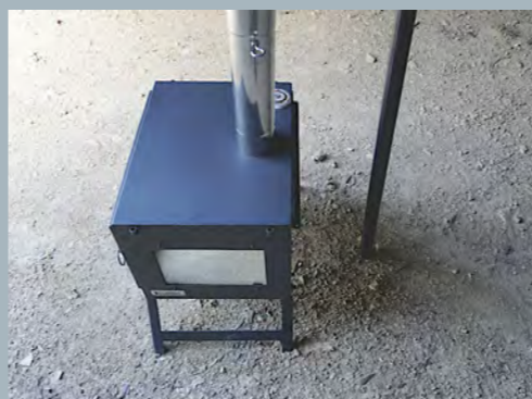
10. トップチムニーホールに煙突を設置した際のセンターポールと薪ストーブの位置関係。
